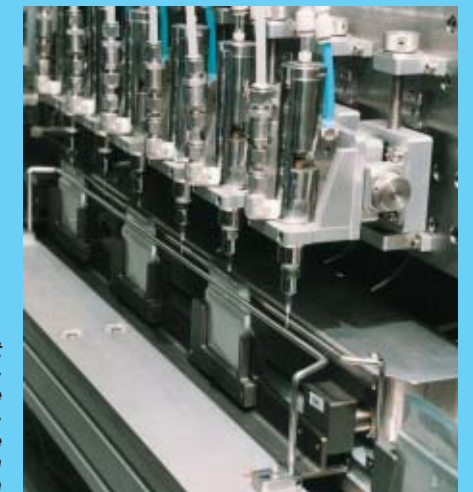
Denn der Pack muss jetzt noch das spezielle Elektrolyt mit aufnehmen. Die Genauigkeit der Dosierung liegt dabei bei sage und schreibe bei einem Fünftausendstel Gramm
