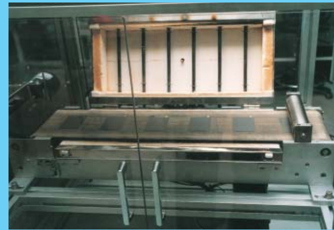
Am Anfang steht bei der Lipo-Herstellung die Anoden- und Kathodenherstellung. Hier im Bild die Anodenstanze
