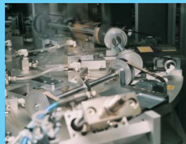
Die Akkühülle besteht aus einer dünnen Aluhaut, die erst tiefgezogen wird (vorne in der Mitte), dann kommt der Batteriepack (rechts) hinein, und hinten kommt dann die andere Aluhülle dazu. Das Ganze verklebt sich durch Erhitzen, wobei eine Seite offen bleibt
