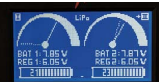
Akku I hatte irgendwann kurzzeitig einen kompletten Spannungsabfall, möglicherweise durch einen Kabelbruch ...
