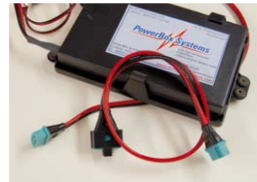
Endlich sind sie da: griffige Multiplex-Steckverbindungen, auch PowerBox-PIK-Stecker genannt
