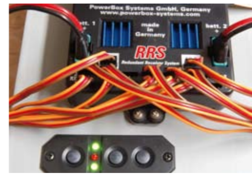
Werden zwei PCM-Empfänger angeschlossen, kommt schon einiges an Patch-Kabeln zusammen (16 dieser Kabel liegen bei)
