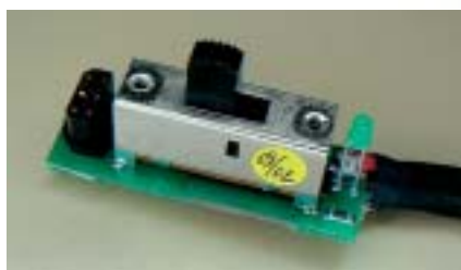
Das Innenleben des Schalters: Ladebuchse, vierpoliger Schalter und Kontroll-LED
