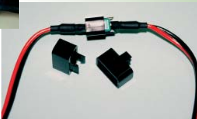
Das Innenleben des Schalters: Ladebuchse, vierpoliger Schalter und Kontroll-LED
