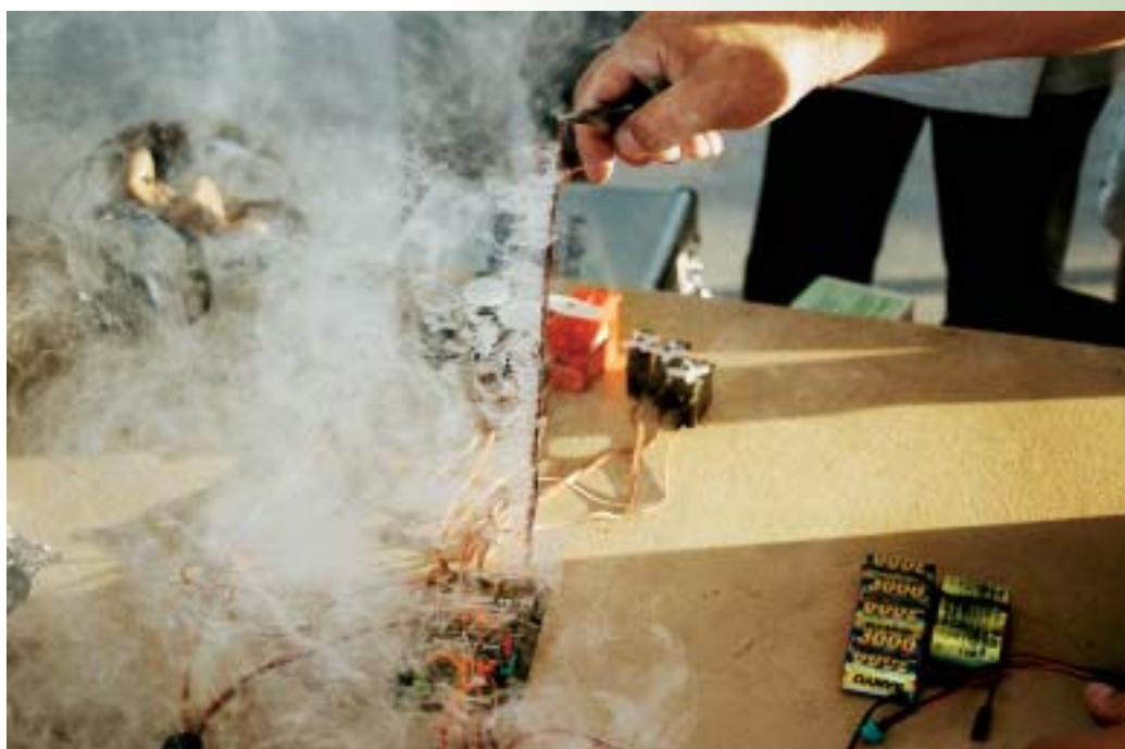
Der Kurzschluss eines Servoausganges oder auch eines Akkupacks hat keinen Einfluss auf die Funktion der restlichen Ausgänge – vorausgesetzt die Kapazität der Akkus ist ausreichend bemessen
