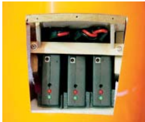
Die Akkus sind zum Laden über einen Deckel zugänglich, zwischen den Akkus ist etwas Luft zur Wärmeabfuhr der integrierten Ladeelektronik notwendig
