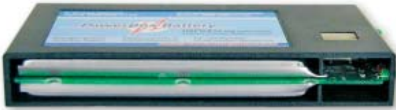
Die LiPo-Akkus werden durch ein stabiles Kunststoffgehäuse geschützt
