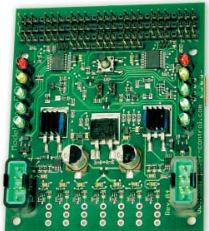
Die Powerbox ist unter Verwendung der Multi-Layer-Technologie aufgebaut und sehr sauber verarbeitet
