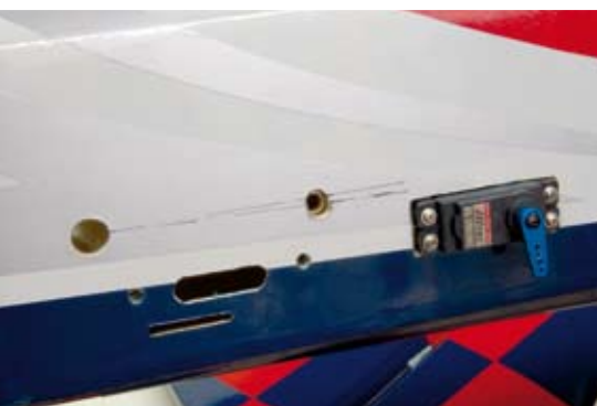
Soll die EWD von minus einem Grad auf plus 0,2 Grad verändert werden, sieht das so aus
