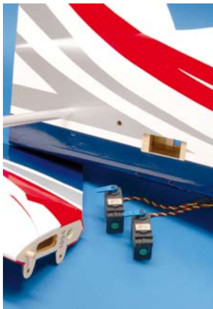
Sperrholzverstärkte Servoaufnahmen für die Höhenruder
