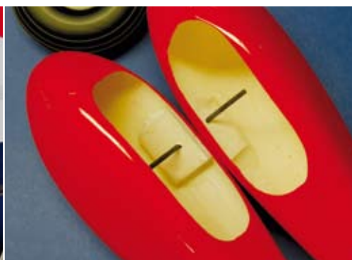
Leider waren die Verstärkungen nicht gleichmäßig verklebt
