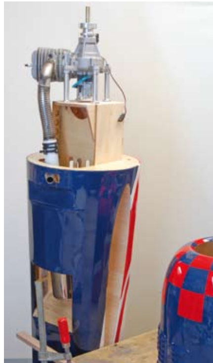
Zur Ausrichtung von Motor und Schalldämpfer eignet sich am besten die senkrechte Stellung
