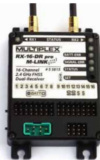
Sowohl die großen Multiplex Pro als auch die telemetriefähigen M-LINK-Empfänger geben nach entsprechender Konfiguration ein digitales, serielles Servosignal am B/D-Port aus
