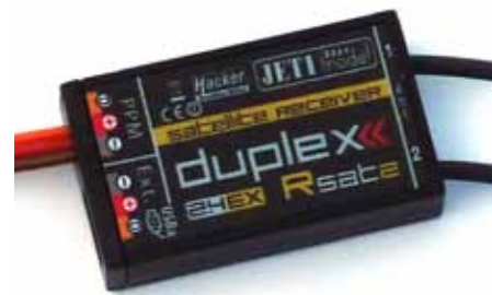
Der Rsat2 von Jeti stellt ein normales Pulsweiten-moduliertes Summensignal bereit
