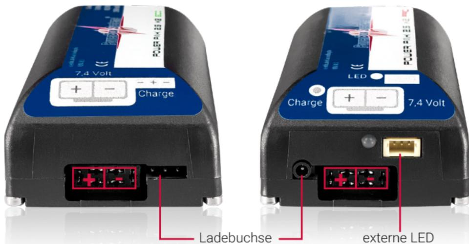
**Hinweis:** Die **PowerPaks** sind als **2s** Empfängerstromversorgung und als **3s** Turbinenstromversorgung verfügbar.
