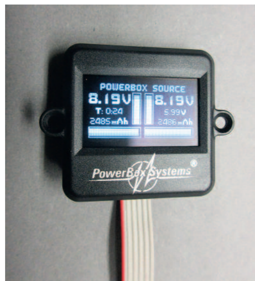
Das optional erhältliche OLED-Display zeigt den Zustand der Akkus an.
