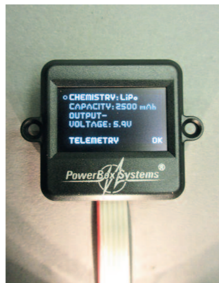
Durch längeren Druck auf die SET-Taste am Schalter gelangt man in das Einstellmenü der Source. Hier kann man die Ausgangsspannung und das Telemetriesystem einstellen.
