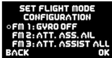
Wichtig im Zusammenhang mit den im Assistenten vordefinierten Flightmode Einstellungen: Diese können jederzeit im **Gyro Settings** Menü geändert werden. Wurde zum Beispiel ein Flightmode als Rate Mode definiert und man möchte z.B. auf dem Querruder doch den Attitude Assist aktivieren, kann man das jederzeit im **Gyro Settings** Menü machen.
