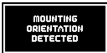
Sie können die **Mercury SRS** in allen Einbaulagen montieren, solange diese im rechten Winkel zur Flugrichtung steht.
