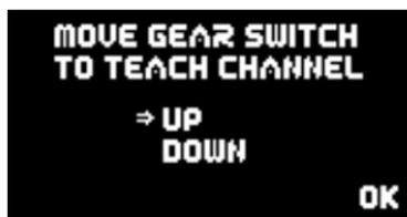
Die **PowerBox** detektiert den Schalter automatisch, sobald Sie am Sender den Schalter betätigen, den Sie für das Fahrwerk zugeordnet haben. Auf dem Bildschirm sollten die Pfeile vor **UP/DOWN** springen. Sollte ihr Fahrwerksschalter jetzt in der Richtung falsch sein, ändern Sie das, indem Sie im Sender den Kanal umpolen. Drücken Sie die SET-Taste um zum nächsten Bildschirm zu kommen.
