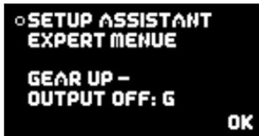
Der **SETUP ASSISTANT** hilft Ihnen den Ablauf des Fahrwerks und der Fahrwerkstüren in wenigen Minuten einzustellen.
