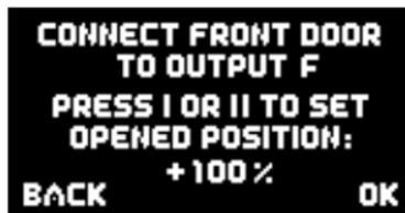
Stecken Sie das Servo für die 1. Bugfahrwerkstüre auf Ausgang F. Fahren Sie mit der SET-Taste zuerst die 1. Bugfahrwerkstüre zu, bestätigen Sie mit der SET-Taste. Im nächsten Einstellbildschirm fahren Sie die 1. Bugfahrwerkstüre auf.
