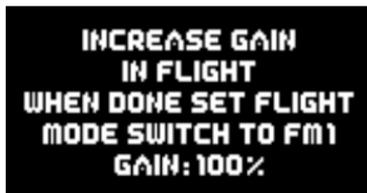
Starten Sie das Modell und fliegen Sie mit Halbgas parallel zur Landebahn. Jetzt wird die Kreiselempfindlichkeit erhöht, bis das Modell auf einer Achse zu Schwingen beginnt. Drehen Sie den Regler zurück, bis das Modell in **allen** Geschwindigkeitsbereichen nicht mehr schwingt.
