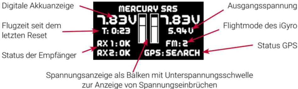
Spannungsanzeige als Balken mit Unterspannungsschwelle zur Anzeige von Spannungseinbrüchen
