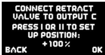
Das Fahrwerk sollte jetzt einfahren. Wenn nicht, drücken und halten Sie die Taste I solange, bis das Ventil schaltet und das Fahrwerk einfährt.
