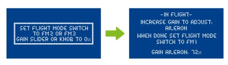
Der **iGyro** wartet jetzt, bis der Flightmode Schalter auf **FM2** oder **FM3** steht, und der Gain Regler auf 0% bevor weiterverfahren wird Jetzt wird aestartet!
