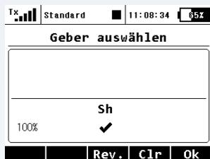
Der Schaltvorgang am Sender kann mit jedem beliebigen Schalter ausgelöst, und per Taste am Display bestätigt werden. Somit kann das Modell nicht aus Versehen abgeschaltet werden. Per Audiofile, kann man den Schaltvorgang akustisch bestätigen lassen.
