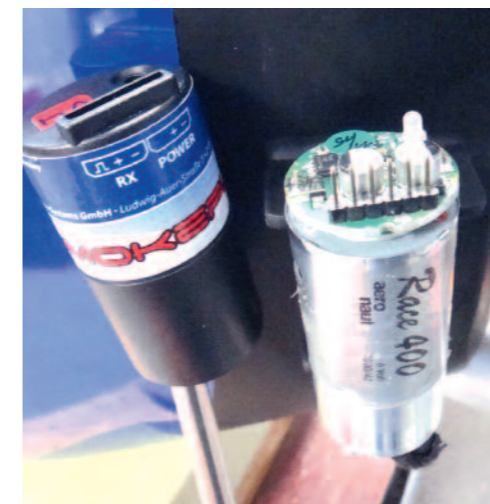
Zieht man die Schutzhülle ab, wird die Platine mit Steuer-elektronik und Leuchtdiode sichtbar. Darunter ist der E-Motor zum Antrieb der Zahnradpumpe platziert.
