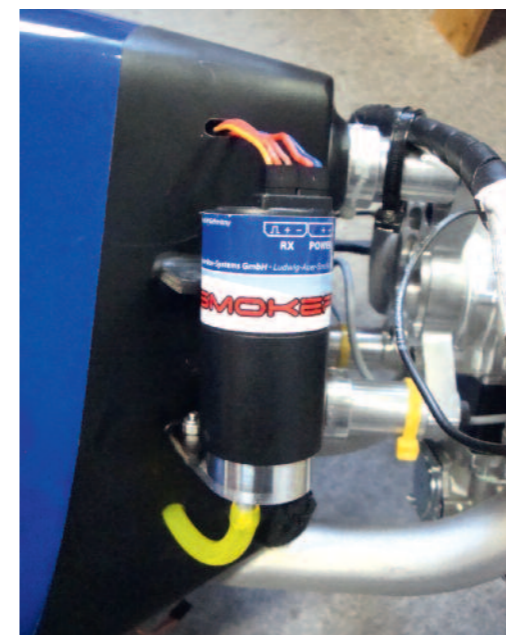
Obwohl das Pumpsystem aufgrund der hohen Präzision der Zahnräder absolut dicht ist, sollte man die Pumpe aufrecht montieren. So ist in jedem Fall sichergestellt, dass auch bei Demontage der Schläuche keine Restmengen der Rauchflüssigkeit auf die Elektronik und Anschlusskabel herunterlaufen.
