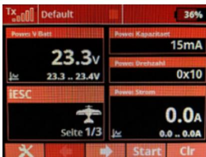
Beim **PowerBox** und Jeti System werden die verfügbaren Telemetrie-Werte wie gewünscht auf das Senderdisplay gelegt.
