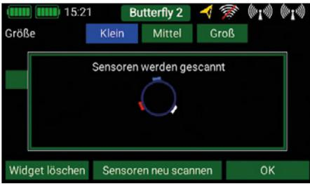
Nach dem Anschließen des Reglers, werden beim Einschalten des Senders alle Sensoren gescannt.
