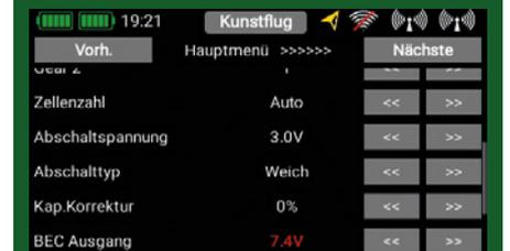
Weiter geht's mit Zellenzahl, Abschalt-Zellspannung, Abschalt-Art und einem Kapazitätskorrekturwert, den man nach einigen Flügen und Ladezyklen einstellen kann, um die Genauigkeit der Kapazitätsanzeige zu optimieren, da der BEC-Verbrauch nicht in die Erfassung eingeht.
