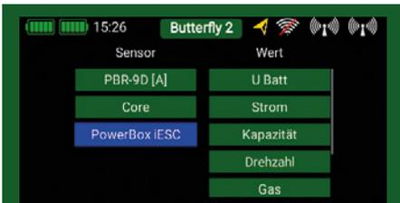
Legt man das erste Telemetrie-Widget an, erscheint der iESC direkt in der Liste der im BUS angemeldeten Komponenten.
