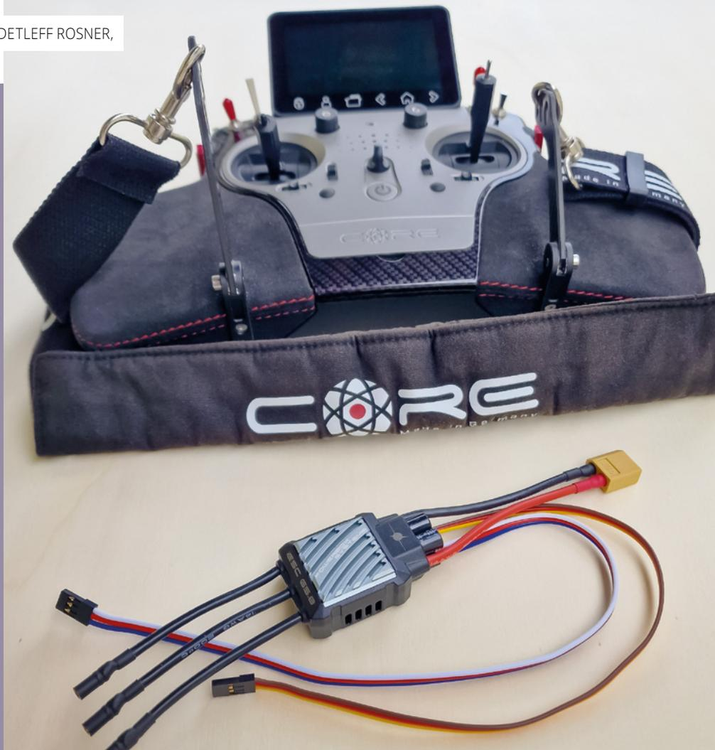
Die beiden neuen Regler sind für den Einsatz an 3 bis 6 bzw. 8s-Akkus ausgelegt und vertragen Spitzenströme von 75 bzw. 135 A. Neben der klassischen Reglerfunktion für Flächenmodelle bieten beide Regler auch einen speziellen Heli-Mode.
