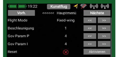
Auf der zweiten Seite des Hauptmenüs kann in den Heli-Mode gewechselt werden und die Beschleunigung angepasst werden. Hier sind auch die Heli-spezifischen Parameter gelistet.
