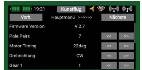
Im iESC-Hauptmenü sind alle einstellbaren Regler-Parameter gelistet, beginnend mit der Polpaar-Zahl, dem Motor-Timing, der Drehrichtung und den Getriebe-Werten.
