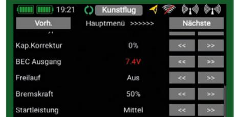
Es folgen die BEC-Ausgangsspannung und der Parameter Freilauf. Damit werden Motordrehzahl und Gasknüppelstellung synchronisiert. Das dient der schnelleren Gasannahme und steigert die Effizienz des Antriebes. Weitere Parameter sind Bremskraft und Startleistung.
