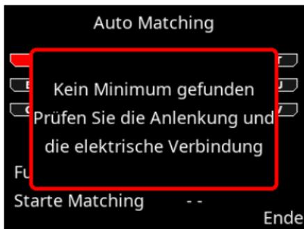
Ein Abgleich von drei Servos dauert ca. 30-40 Sekunden. Sie können den Stromverbrauch direkt am Display mitverfolgen. Wenn der Abgleich beendet ist, fahren Sie testweise alle 5 Punkte mit dem Steuerknüppel an. Ein leichtes Summen der Servos in der einen oder anderen Position ist normal. Wenn Sie das Ruder leicht mit dem Finger berühren und das Summen aufhört, wird deutlich, dass der Abgleich präzise gearbeitet hat.
