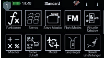
1) Der Funktionsumfang der Atom wird in unterschiedlichen Kacheln strukturiert. 2) Es lassen sich auch Telemetrie-Sensoren von Fremdherstellern an den P²-Bus anschließen. Hier wurde ein SM MicroVario als Sensor erkannt. Rechts daneben werden die jeweils verfügbaren Telemetriewerte zu jedem Sensor angezeigt. 3) Hier wurde ein Motor-Timer realisiert, der erst rückwärts zu zählen beginnt, wenn sowohl der Gas-Schalter, als auch der Gas-Not-Aus-Schalter in der richtigen Stellung stehen
