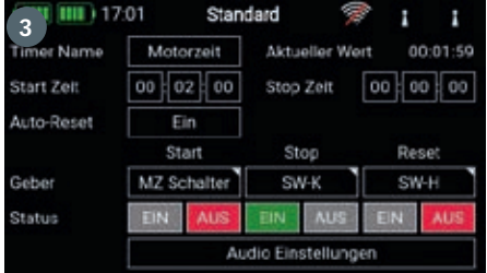
1) Der Funktionsumfang der Atom wird in unterschiedlichen Kacheln strukturiert. 2) Es lassen sich auch Telemetrie-Sensoren von Fremdherstellern an den P²-Bus anschließen. Hier wurde ein SM MicroVario als Sensor erkannt. Rechts daneben werden die jeweils verfügbaren Telemetriewerte zu jedem Sensor angezeigt. 3) Hier wurde ein Motor-Timer realisiert, der erst rückwärts zu zählen beginnt, wenn sowohl der Gas-Schalter, als auch der Gas-Not-Aus-Schalter in der richtigen Stellung stehen
