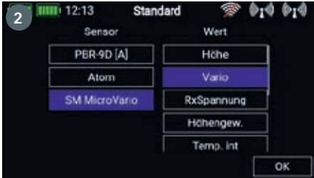
1) Der Funktionsumfang der Atom wird in unterschiedlichen Kacheln strukturiert. 2) Es lassen sich auch Telemetrie-Sensoren von Fremdherstellern an den P²-Bus anschließen. Hier wurde ein SM MicroVario als Sensor erkannt. Rechts daneben werden die jeweils verfügbaren Telemetriewerte zu jedem Sensor angezeigt. 3) Hier wurde ein Motor-Timer realisiert, der erst rückwärts zu zählen beginnt, wenn sowohl der Gas-Schalter, als auch der Gas-Not-Aus-Schalter in der richtigen Stellung stehen
