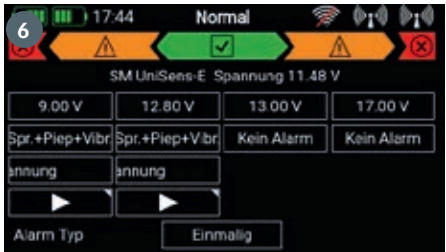
4) Über den Dateimanager lassen sich Daten von oder auf einen USB-Stick kopieren. 5) Kurzer Blick auf das Vario-Menü: Es lassen sich verschiedene Parameter einstellen und so das Verhalten des Varios bestmöglich auf die Wünsche des Piloten anpassen. 6) Bei den Alarmen werden verschiedene Wertebereiche farblich definiert und es können Ereignisse zugeordnet werden, beispielsweise ein Piepton, eine Sprachausgabe und/oder eine Vibration
