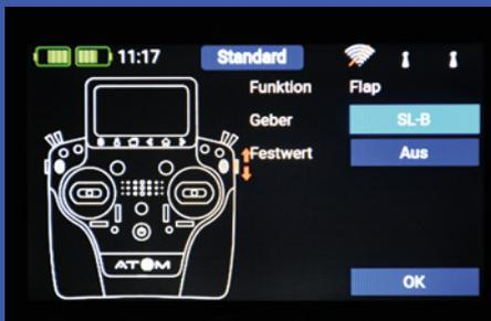
Perfekt gelöst aus meiner Sicht, weil maximal einfach und übersichtlich, ist die Zuordnung eines Gebers zur Funktion durch Betätigen des Sticks, Schalters, Schiebers oder Tasters. Die roten Pfeilchen verdeutlichen, dass ich für die Flaps den rechten seitlichen Lineargeber ausgewählt habe.
