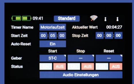
Höchste Ansprüche von Schauflug- und Wettbewerbspiloten bedient auch das Timer-Menü, wo bis zu acht unterschiedliche und unabhängige Timer angelegt werden können. Geber und Schaltpunkte lassen sich ebenso einstellen wie die Alarmer und Sprachansagen.
