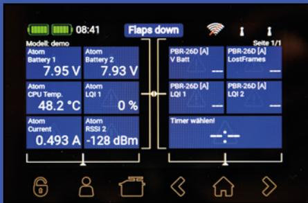
Der Homescreen des PowerBox-Demomodells zeigt die Vitaldaten des Senders. Auf der Seite ist Platz für maximal 12 Widgets. Was die Kacheln anzeigen, bestimmt der User. Praktisch: Die Schnellzugriffssymbole unten beschleunigen und vereinfachen die Navigation durch die Menüs.
