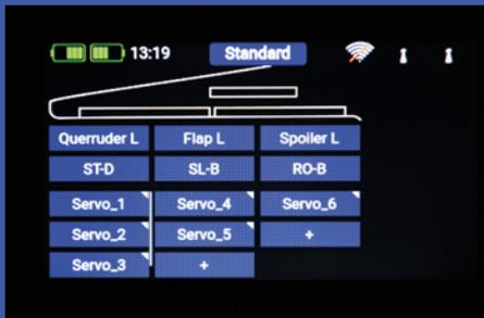
Vorlagen helfen, wo es Sinn acht. So simpel sind die Grundlagen für die Programmierung des Vielklappenflügels eines Großseglers gelegt. Der Funktion „Quer links“ wurden z. B. drei Servos zugeordnet, die getrennt voneinander hinsichtlich sämtlicher Parameter eingestellt werden können.
