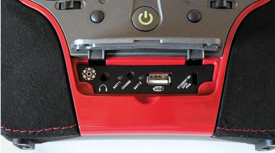
Unter der Frontklappe (v. l.): Kopfhörerausgang; Ladebuchse für beide Senderakkus; USB-Anschluss für Updates, was auch via Wi-Fi funktioniert; Student RX/PPM greift das Bus-Signal des Empfängers eines Schülersenders ab oder dient zum Direktanschluss eines Servos, z. B. zum Neutralstellen.
