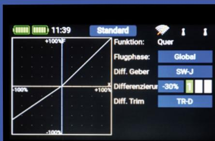
Von supersimpel bis megamächtig reicht die Bandbreite im Menü Differenzierung, die sich prinzipiell auf alle Funktionen anwenden lässt. Eingestellt werden kann eine Differenzierung mit Festwert, Geber, Trimmgeber und das Ganze auch noch flugphasenabhängig.
