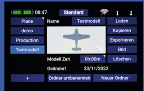
Der Menüpunkt „Modell“. Links die Liste mit den bereits angelegten Modellspeichern, rechts die Möglichkeit, ein Modell auf einen USB-Stick zu exportieren. Der Austausch funktioniert zwischen zwei Atoms und auch mit der PowerBox Core. Ästheten hinterlegen hier noch ein Foto des Modells.
