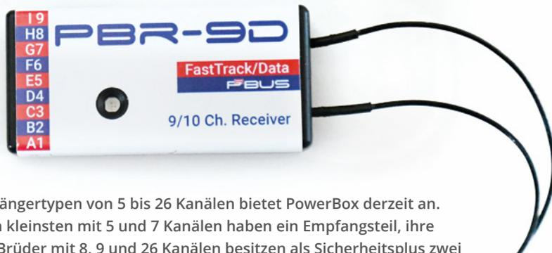
Fünf Empfängertypen von 5 bis 26 Kanälen bietet PowerBox derzeit an. Die beiden kleinsten mit 5 und 7 Kanälen haben ein Empfangsteil, ihre größeren Brüder mit 8, 9 und 26 Kanälen besitzen als Sicherheitsplus zwei gleichwertige Empfangssysteme. Der PBR-9D liegt der Atom bei.
