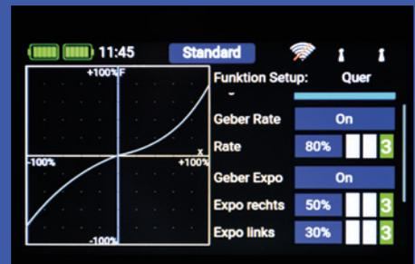
Standards wie Dual Rate und Expo lassen sich jeder Funktion – selbstverständlich schaltbar – zuordnen. Zu den umfangreichen Einstellmöglichkeiten gelangt man mit einem Touch vom Funktionsmenü aus.
