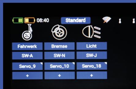
Scale-Piloten werden bestens bedient. Für Sonderfunktionen wie Fahrwerk und Beleuchtung stehen eigene Menüpunkte zur Verfügung. Ein äußerst potenter Doorsequenzer steuert bis zu 6 Servos mit bis zu 7 Wegpunkten an. Zwei unabhängige Sequenzen können erstellt und geschaltet werden.
