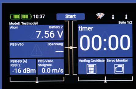
Zum Kennenlernen der Atom habe ich gleich mal einen eigenen Homescreen zusammengestellt. Neben Telemetrie und Timer können auch Direktzugriffe z. B. auf den Servomonitor hinterlegt werden. Per Drag and Drop lassen sich die Kacheln positionieren.
