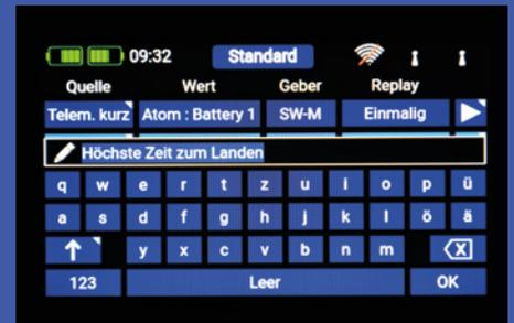
Ein Highlight ist die Sprachausgabe mit sehr gut funktionierender Text-to-Speech-Funktion. Bis zu 64 Zeichen darf die Eingabe umfassen. Weiterhin kann die Atom Telemetrie-Werte melden (kurz, mittel oder alles) sowie Timer-Ansagen in Klartext durchführen, alles auf Wunsch (ab-)schaltbar.
