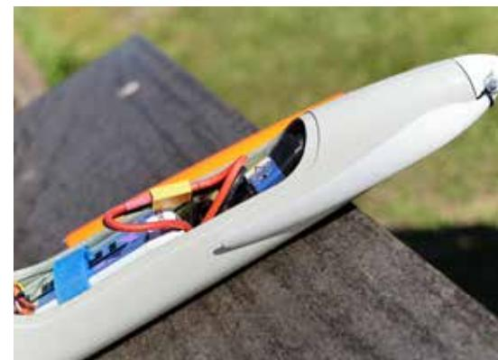
Der Einbau des „GPS-V“ im Modell mit Klettband auf dem Servobrett.
