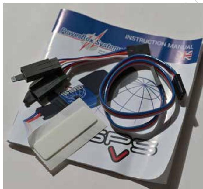
den. Dafür stehen bei den Telemetriedaten (GPS und Variometer) bis zu 15 Werte zur Verfügung: GPS-Höhe, Geschwindigkeit, Entfernung in 2D und 3D, zurückgelegte Strecke, Flugrichtung, Anzahl der Satelliten, Genauigkeit, Steigrate, Höhe in Metern oder Zentimetern, Temperatur, GPS-Koordinaten und Status des Sensors. Powerbox-Systems stellt höchste Ansprüche an den „GPS-V“. Hervorheben möchte ich die vielseitige Unterstützung der unterschiedlichen Protokolle.
