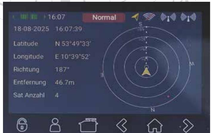
Die abgebildeten GPS-Daten zum Auffinden des Modells. Der rote Punkt zeigt die Lage des Modells. Die genauen Koordinaten und die Entfernung werden ebenso angezeigt.
