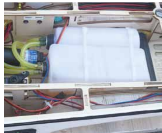
In der MXS-R ist die SmokePump mittels eines Alu-Winkels am Rumpfboden verschraubt. Die beiden Kabel sind seitlich im Modell verlegt und an die PowerBox Evolution angeschlossen. Die Tanks passen in der Breite gerade so hinein
