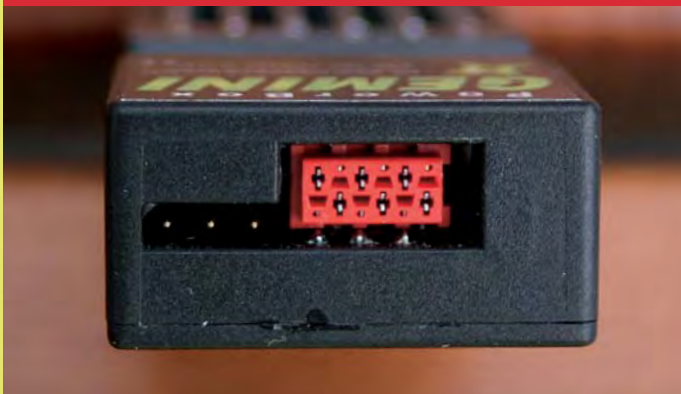
An der anderen Querseite befindet sich der Anschluss für den Sensor-schalter und links daneben der Kreiselschluss.
