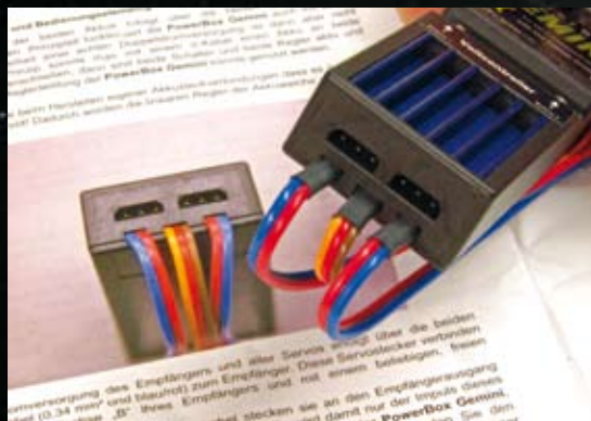
Oberhalb der beiden Ausgänge für Empfänger und Steuereingang des Kreisel systems liegen die Eingänge der Akkus
