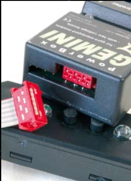
Der Anschluss für den Sensorschalter liegt geschützt im Gehäuse des Gemini. Links davon befindet sich der Gyro-Connector
