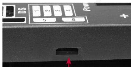
Anschluss für **USB Interface** und Telemetrie: **P<sup>2</sup>BUS**, M-Link, HoTT und Jeti
