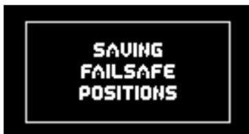
Prüfen Sie die Einstellungen, in dem Sie alle Funktionen mit dem Sender in die „Nicht Failsafe Position“, also z.B. beim Gas die Vollgasstellung bringen. Schalten Sie jetzt den Sender aus. Alle Ausgänge die im **OUTPUT MAPPING** Menü mit **FS** gekennzeichnet wurden, nehmen jetzt die eingelernte Stellung ein. Alle mit **HD** gekennzeichneten Ausgänge bleiben in der zuletzt bekannten Position stehen.
