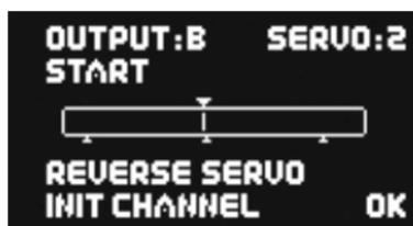
Zu sehen sind der graphisch dargestellte Ausgangsblock, die Kennung des Ausgangs und die zugeordnete Funktion des Ausgangs.
