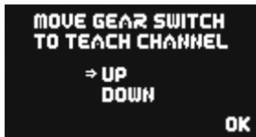
Die **PowerBox** detektiert den Schalter automatisch, sobald Sie am Sender den Schalter betätigen, den Sie für das Fahrwerk zugeordnet haben. Auf dem Bildschirm sollten die Pfeile vor **UP/DOWN** springen. Sollte ihr Fahrwerksschalter jetzt in der Richtung falsch sein, ändern Sie das, indem Sie im Sender den Ausgang umpolen. Drücken Sie die **SET**-Taste um zum nächsten Bildschirm zu kommen.
