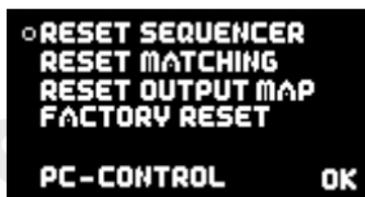
Bei der Auswahl einer der Reset-Optionen wird zur Sicherheit noch eine Bestätigung abgefragt, um versehentliches Löschen zu vermeiden. Wird diese Abfrage bestätigt sind die Einstellungen nicht wiederherstellbar.
