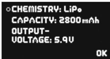
Wollen Sie eine der Einstellungen verändern, bewegen Sie den Cursor mit den Tasten **I** und **II** zum entsprechenden Menüpunkt und wählen diesen mit der **SET**-Taste aus (Cursor ist nun ein ausgefüllter Kreis). Ändern Sie jetzt mit den Tasten **I** und **II** den Wert. Nachdem der gewünschte Wert ausgewählt ist, bestätigen Sie diesen mit der **SET**-Taste. Damit wird der Wert gleichzeitig abgespeichert. Zum Hauptmenü gelangen Sie über den Menüpunkt **OK**.
