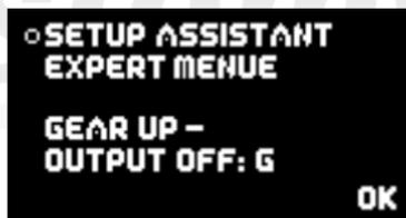
Der **SETUP ASSISTANT** ist eine Funktion in der **Cockpit SRS** und seit der Softwareversion V15 eingebaut. Damit wird die Programmierung der eigentlichen Doorsequenzer Funktion deutlich vereinfacht.
