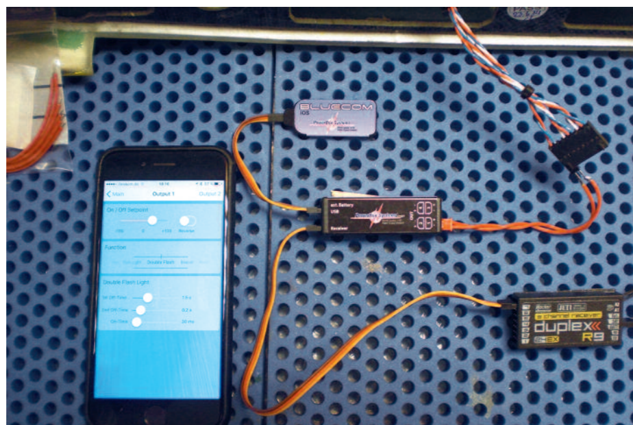
Nachdem der BlueCom-Adapter in die USB-Buchse eingesteckt ist, wird die PowerBox-App auf dem Handy gestartet und die LightBox ausgewählt.
