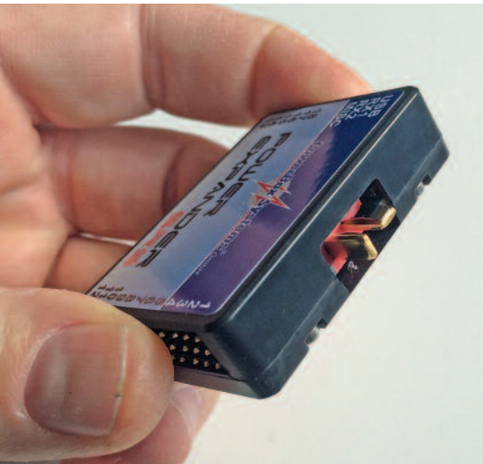
Das Warten für Futaba-Anwender hat ein Ende. Mit dem PowerExpander SRS ist es möglich, mit kleinen, aber vollwertigen Empfängern alle Kanäle des Fernsteuersystems zu nutzen. Der PowerExpander ist wahlweise mit Dean- (Bild oben) oder MPX-Stecker (Bild unten) verfügbar.
