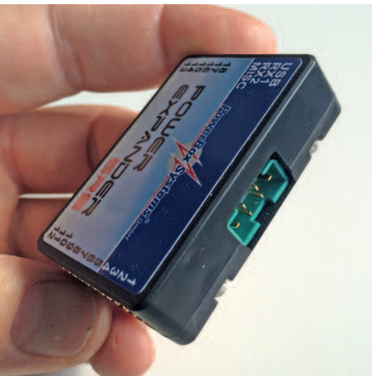
Das Warten für Futaba-Anwender hat ein Ende. Mit dem PowerExpander SRS ist es möglich, mit kleinen, aber vollwertigen Empfängern alle Kanäle des Fernsteuersystems zu nutzen. Der PowerExpander ist wahlweise mit Dean- (Bild oben) oder MPX-Stecker (Bild unten) verfügbar.
