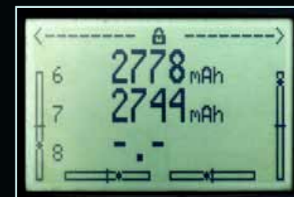
... und so die Restkapazität beider Akkus im Display eines ROYAL Pro-Senders angezeigt
