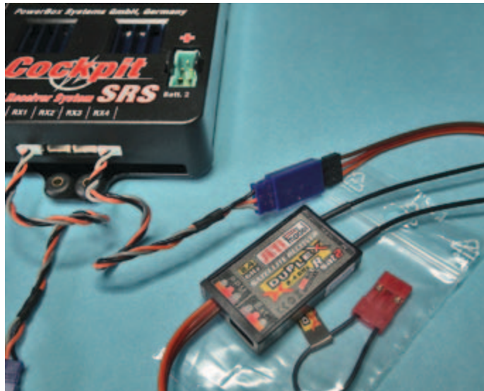
Die Cockpit-SRS bietet Schnittstellen für Jeti-Satelliten. Es können sowohl Satelliten des Typs 1 als auch (besser) die hier gezeigte Version 2 verwendet werden.
