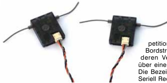
Spektrum-Satelliten sind vollwertige Empfangseinheiten mit einem digitalen, seriellen Servosignal am Ausgang
