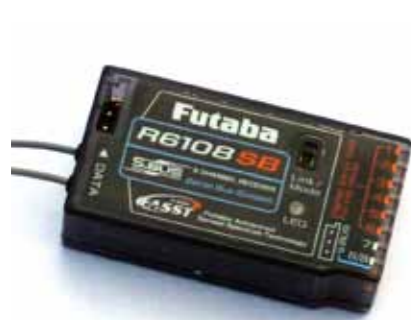
Die S-Bus-Empfänger von robbe/Futaba stellen eine serielle Schnittstelle bereit, an der ein spezifisches, digitales Summensignal ausgegeben wird
