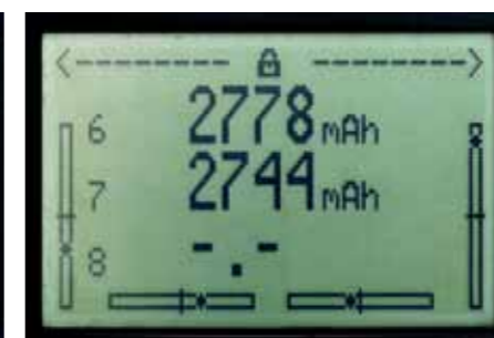
... Restkapazität beider Akkus im Display eines ROYAL-Pro-Senders angezeigt
