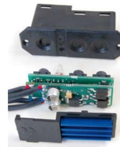
Zwei übereinander angebrachte, doppelseitig bestückte Platinen mit großem Kühlkörper ergeben einen kompakten Aufbau bei hoher Leistung
