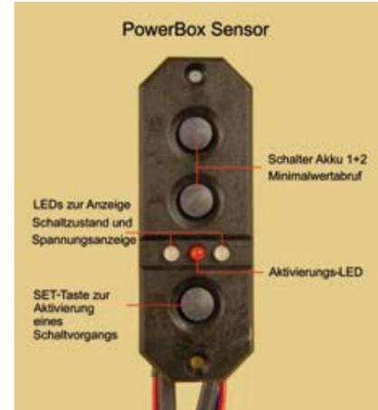
**Bedienungstasten und Kontrollanzeigen des PowerBox Sensor**
