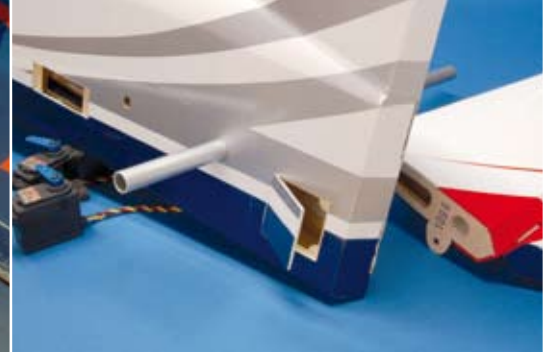
Selbst eine Zugangsklappe ist vorhanden
