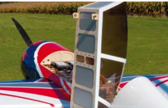
Die große, abnehmbare Rumpfabdeckung sorgt für einen optimalen Zugang
