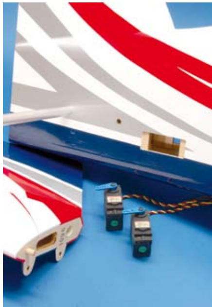
Sperrholzverstärkte Servoaufnahmen für die Höhenruder
