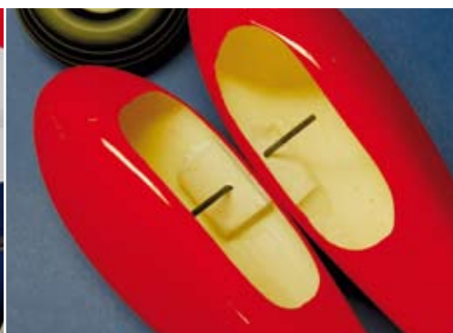
Leider waren die Verstärkungen nicht gleichmäßig verklebt
