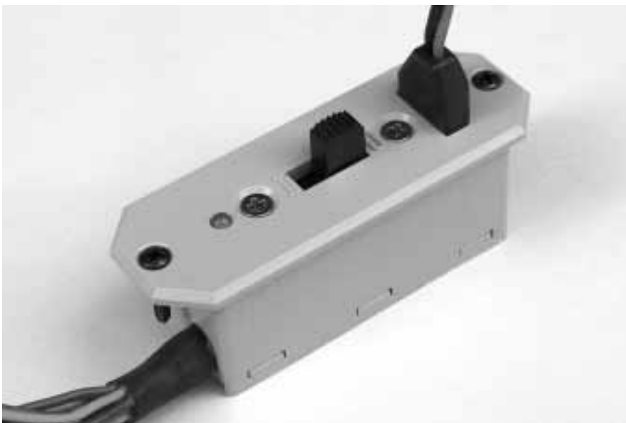
Über die Ladebuchse können beide Akkus gleichzeitig geladen werden
