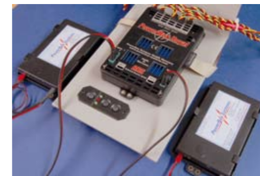
Zwei PowerBox-Akkus mit 2.800 Milliamperestunden Kapazität versorgen die PowerBox Royal
