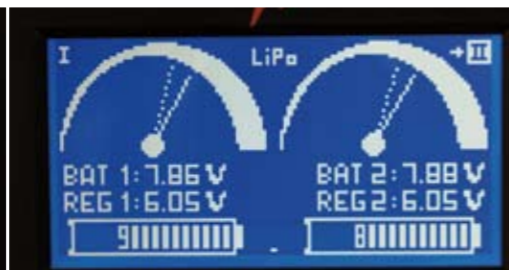
Empfänger I ist ausgefallen, II hat übernommen
