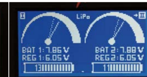
Obwohl Empfänger I wieder verwertbare Servosignale ausgibt, bleibt II weiterhin aufgeschaltet
