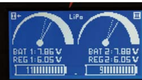
Beide Empfänger funktionieren einwandfrei. Die Signale von RX I werden verwendet. Der gestrichelte Schleppezeiger zeigt den Spannungsabfall aufgrund des Akkutests
